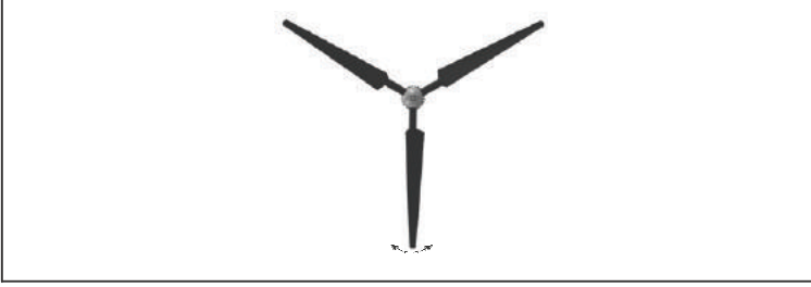
Şek. 7 Rotoru Dengeleyin (Y-Konumu)
